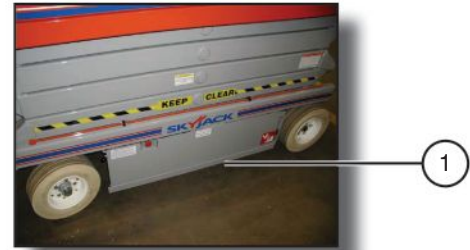
Figura 2-7. Dispositivo de proteção contra buracos
